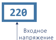
Рисунок 5.2 - Примеры изображений на индикаторе стабилизатора («начальный экран»)
